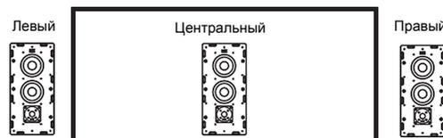
При использовании модели IW950 с акустически непрозрачным экраном центральный канал может быть расположен горизонтально под или над экраном, а правый и левый каналы необходимо переместить вверх или вниз, чтобы они были напротив горизонтально расположенного центрального канала.
