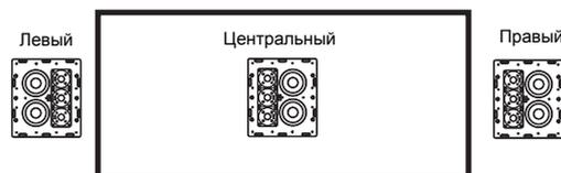
При использовании моделей IW300 и IW150 с акустически непрозрачным экраном центральный канал можно разместить над или под экраном, а левый и правый каналы переместить вверх или вниз, чтобы они были напротив центрального канала (рис. А).
