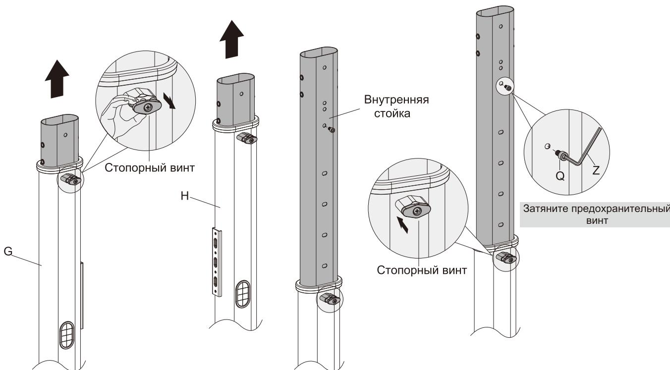
Потяните стопорный винт на себя и одновременно тяните внутреннюю стойку вверх до необходимой высоты.
