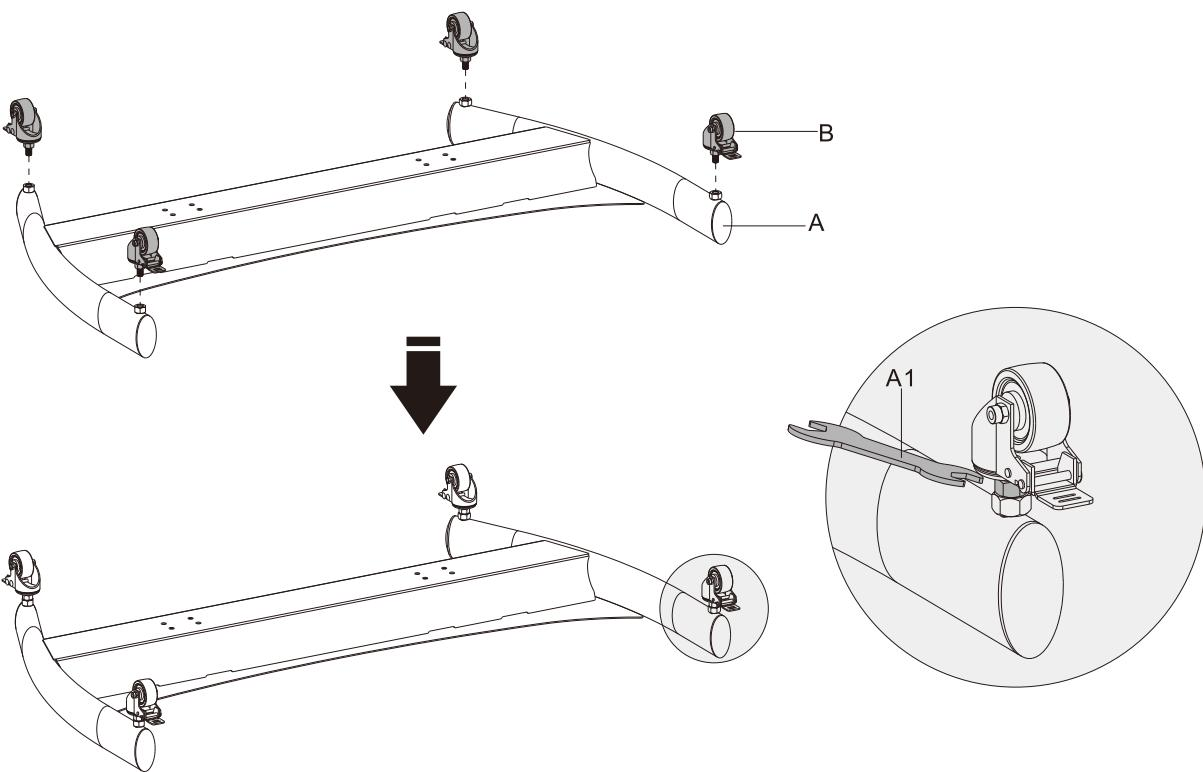
**ВНИМАНИЕ:** Во избежание случайного движения конструкции во время сборки заблокируйте ролики при помощи тормоза. Высоту каждого ролика можно настроить индивидуально. Ослабьте нёмного гайку для того, чтобы поднять или опустить основание.
